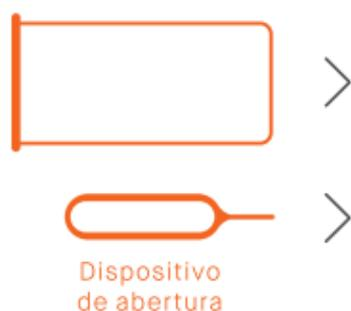
Insira o dispositivo de abertura no orifício lateral. Em seguida, retire a bandeja.
