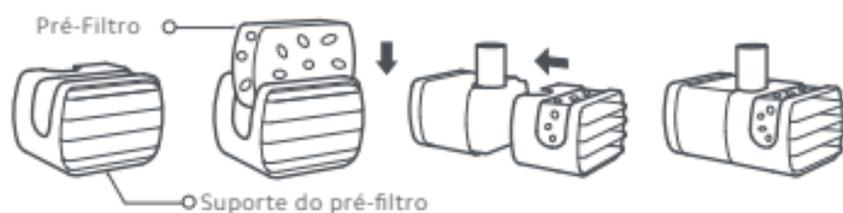
Coloque o pré-filtro no suporte do mesmo e de seguida instale o suporte na bomba de água.
