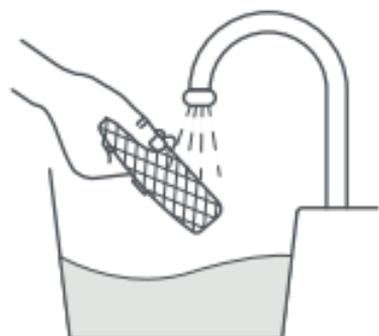
1. Passe o filtro por água por dois minutos para remover o pó de carbono resultante das colisões do carvão ativado durante o transporte
