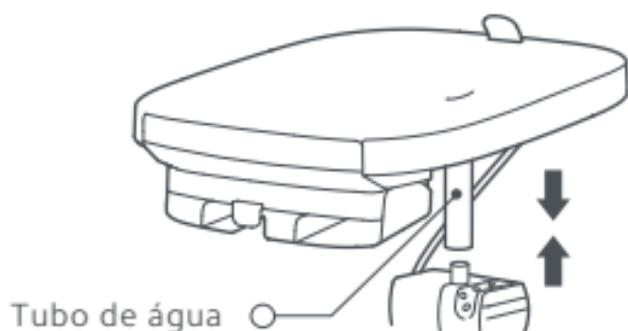
Ligue as pontas do tubo de água à tampa e à bomba de água.
