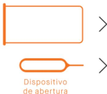
Insira os cartões nano SIM e cartão MicroSD de sua preferência, conforme a imagem à direita. Em seguida, recoloque a bandeja no aparelho.
