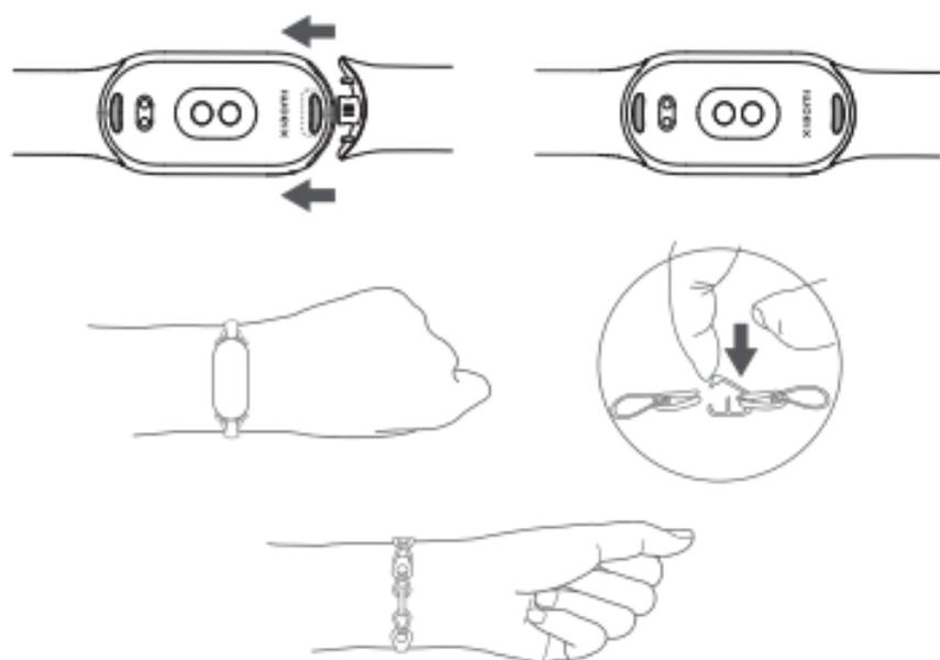
Alinhe o bracelete com o monitor de atividade física e encaixe as duas partes. Confira antes do uso para garantir está preso com segurança.
