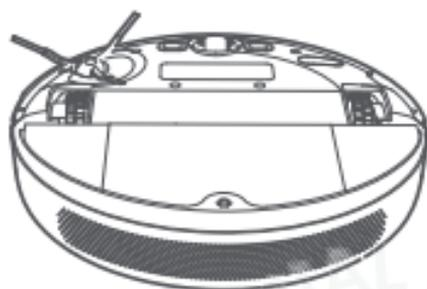
1. Vire o aspirador e pressione e segure os dois solte os cliques de trava para remover a tampa da escova.
