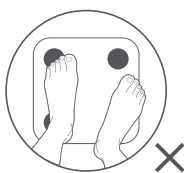
Contato insuficiente ou inadequado de ambos os pés com os eletrodos metálicos
