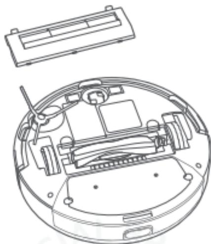
1. Vire o aspirador e pressione os dois pontos de trava para remover a tampa da escova central.
