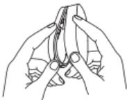
b. Remova a bateria utilizando uma ferramenta não metálica.
