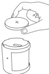
c. Insira uma bateria com especificação CR2450 no compartimento de bateria.
