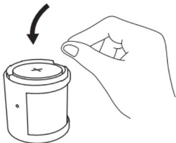
d. Coloque a tampa da bateria no topo do sensor e gire no sentido horário.
