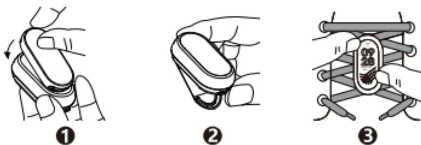
1. Pressione e encaixe o corpo do monitor de atividade física na cavidade do clipe de corrida na direção correta.
