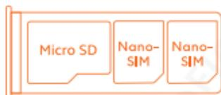
A bandeja deste modelo permite o uso simultâneo de dois chips nano-SIM e um cartão MicroSD.
