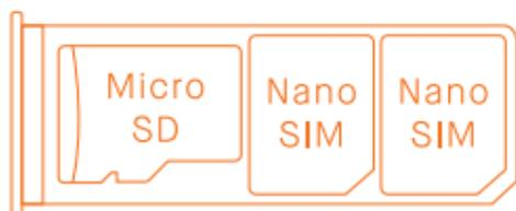
A bandeja deste modelo, permite o uso de dual nano SIM e um cartão MicroSD.
