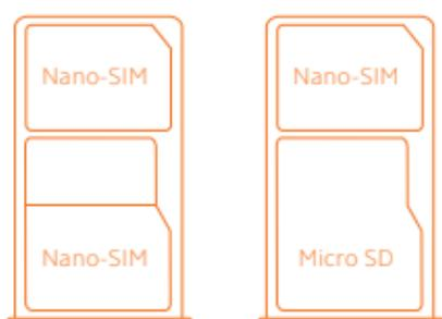
O slot deste modelo permite apenas o uso de dual chip ou um cartão MicroSD e chip nano SIM.
