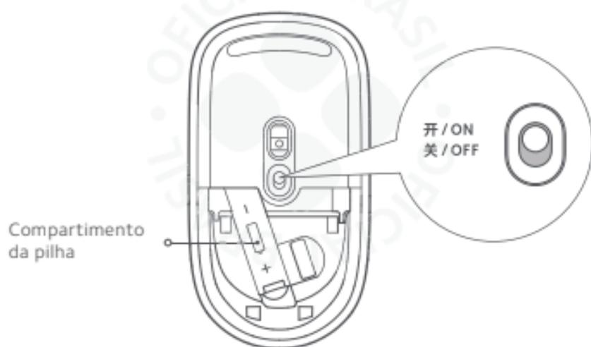
3. Retire o receptor nano e ligue-o à porta USB do computador ou do dispositivo desejado. Em seguida, feche o compartimento de pilha e use o interruptor de alimentação para ligar o mouse.
