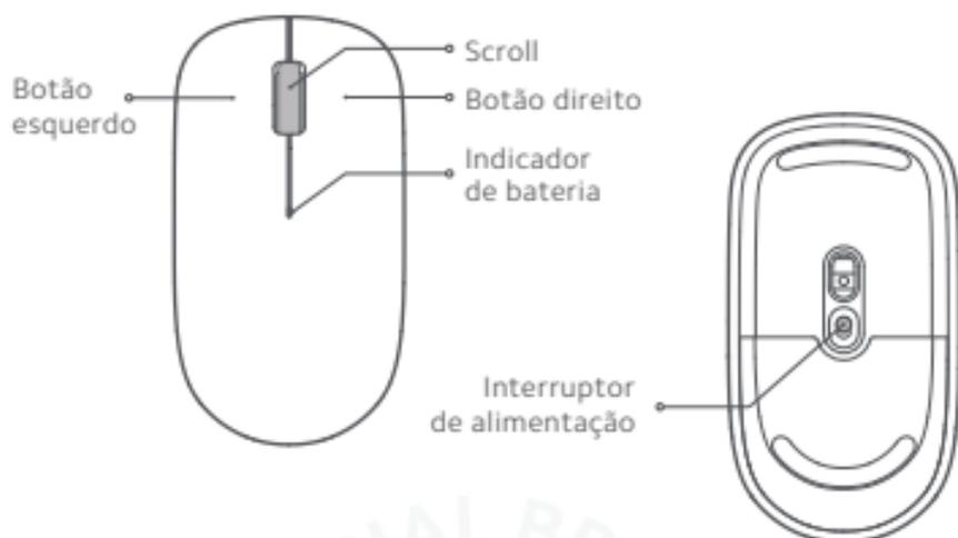
O Xiaomi Wireless Mouse Lite utiliza tecnologia sem fios de 2,4 GHz. Basta ligar o receptor nano ao computador para começar a utilizar o mouse. Com uma forma ergonômica, o Mouse Sem Fio Xiaomi Lite é um bom parceiro para o seu computador.
