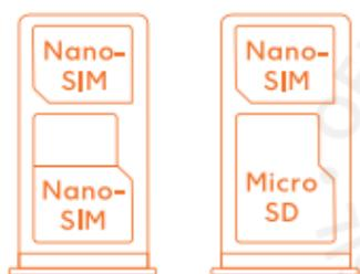
A bandeja deste modelo, permite apenas o uso de dual chip ou um cartão MicroSD e chip nano-SIM.
