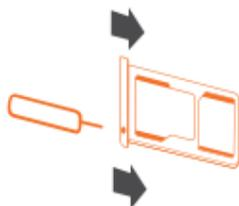
Insira os cartões nano-SIM ou um cartão nano-SIM e MicroSD de sua preferência, conforme a imagem à direita. Em seguida, recoloque a bandeja no aparelho.
