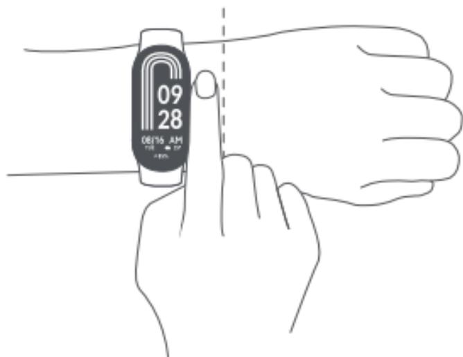
Ajuste confortavelmente a pulseira em torno do seu pulso, usando como referência um dedo de largura do osso do seu pulso. Ajuste a pulseira para garantir que o sensor de frequência cardíaca possa coletar os dados normalmente.
